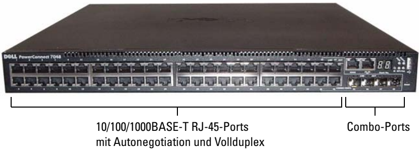
Abbildung 1-4. PowerConnect 7048 mit 48 10/100/1000BASE-T-Ports
